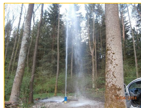
Pozitivní výtlačná úroveň na průzkumném hydrogeologickém vrtu HVS-3 (přetlak 140 kPa) na lokalitě Suchov
