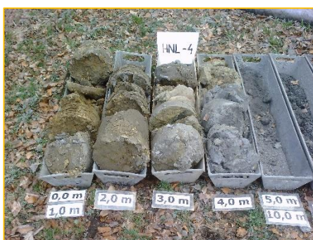
Popis vrtného jádra průzkumného hydrogeologického vrtu HNL-4, metráž 0-10 m (lokalita Nová Lhota)
