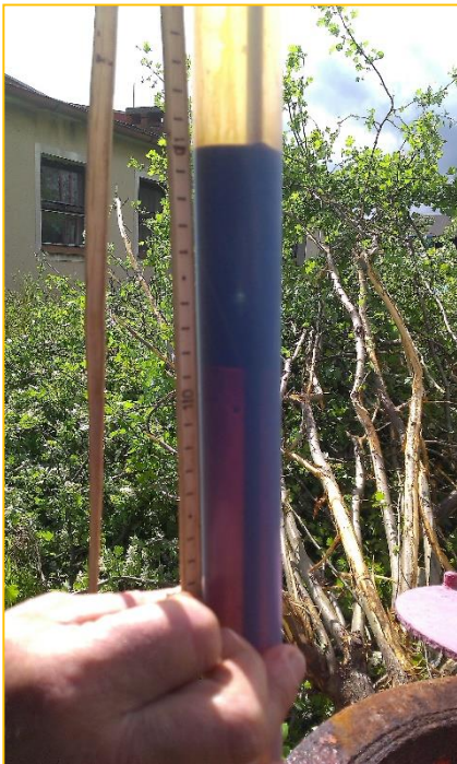
Měření mocnosti volné fáze ropných látek před zahájením sanace
