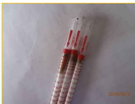
UH-V detekční trubice po reakci s ropnými uhlovodíky v půdním vzduchu
