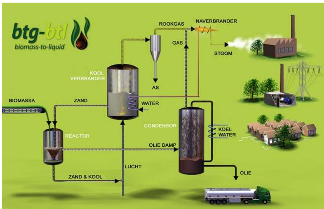
Obrázek č. 3 Proces pyrolýsní konverze zemědělských odpadů na naftu vyvinutý Universitou Twente (Anonym, 2010A)
