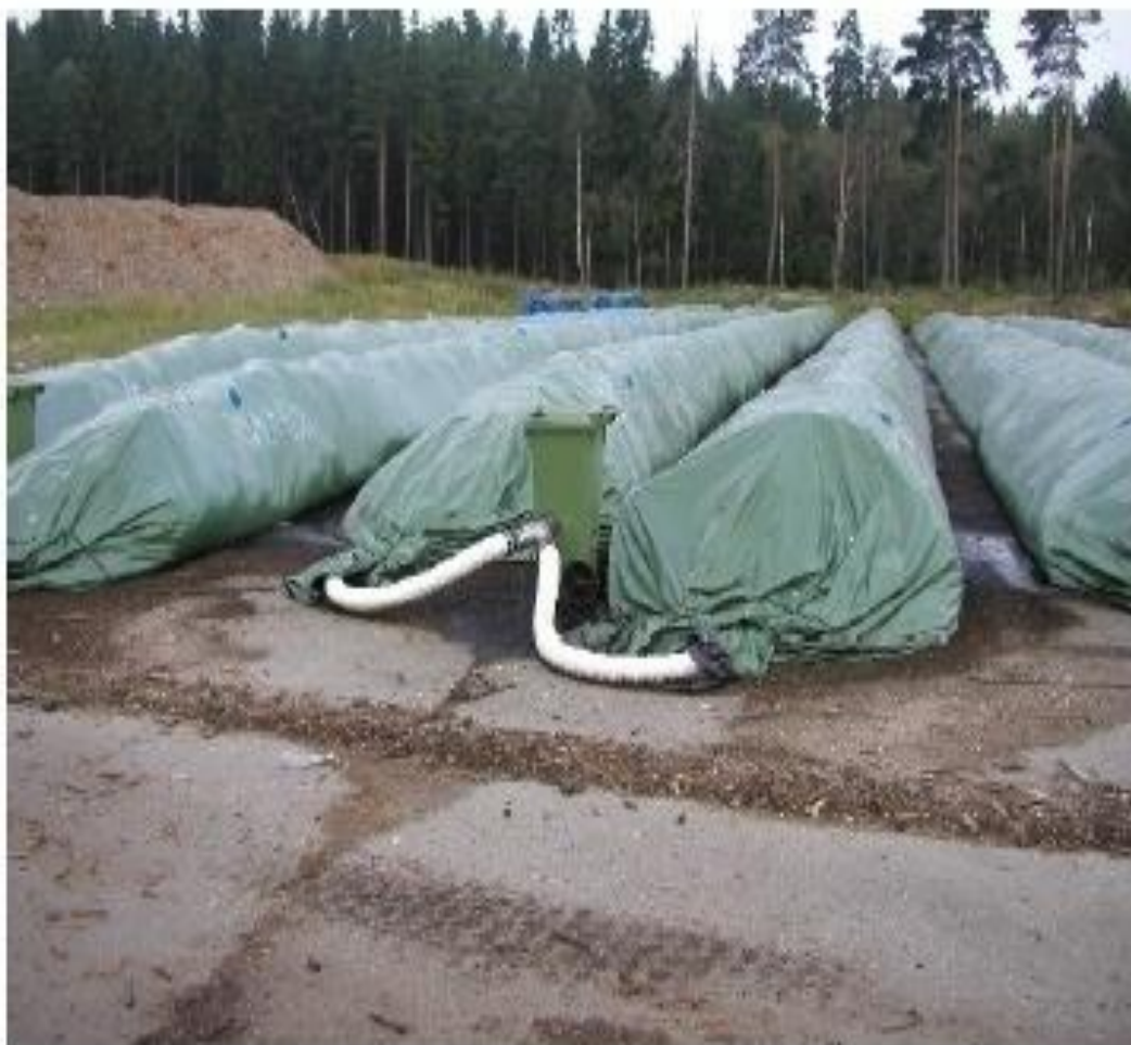
Obr. 6: Kompostovací vaky AG-BAG v provozu na kompostárně ve Švédsku
