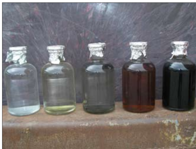
Obr. 15: Vzorky zleva: 1. pitná voda z nekontaminované studny, 2. přečištěná podzemní voda ze sanační stanice, 3. kontaminovaná podzemní voda ze studny, 4. odsazený produkt ze sanační stanice z podniku Agromontáž, 5. odsazený produkt z podniku Elevatorul
