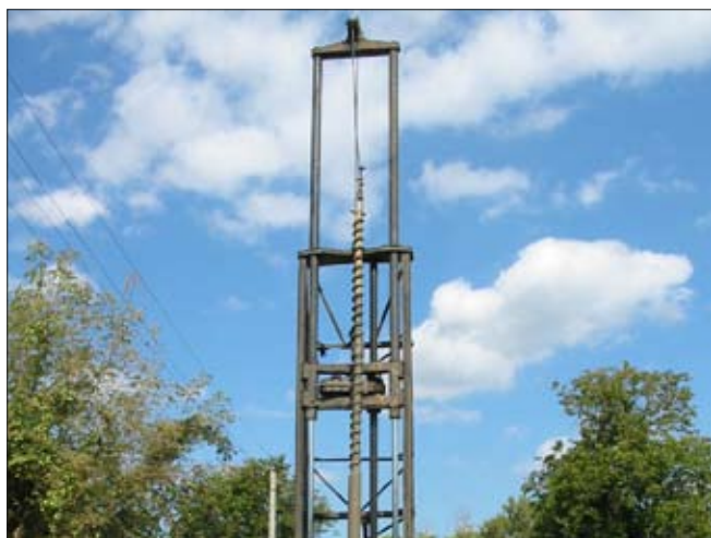
Obr. 13: Vrtná souprava UGR se spirálovým vrtákem
