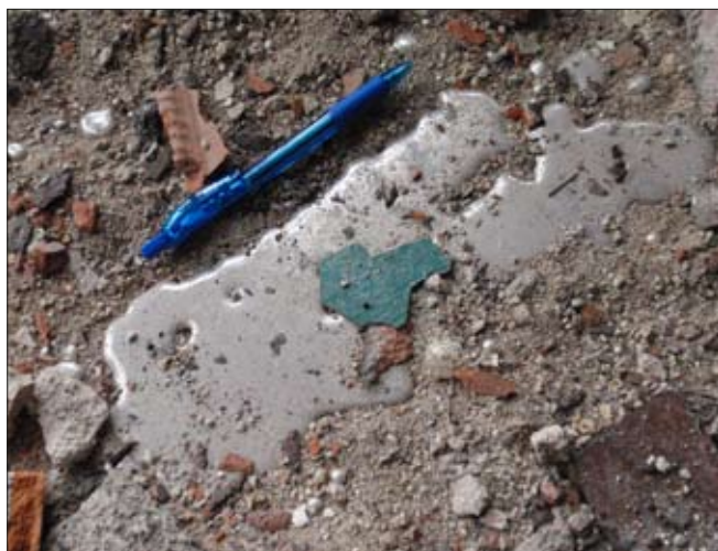
Obr. 21: Rtuť se nachází na podlaze ve formě kapek v mnoha částech objektu budovy bývalé elektrolyzy
