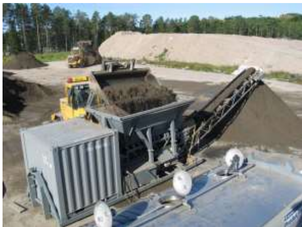
Obr. 2 Technologie pro zapravení bakteriálního preparátu a minerálních živin do zeminy při biodegradaci
