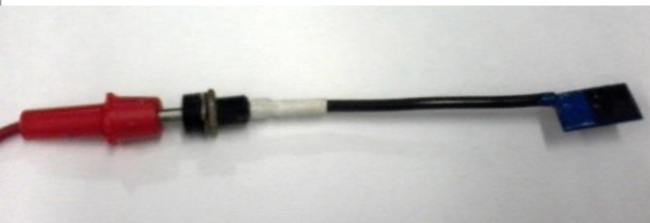
Borem dopovaná diamantová anoda ( S=22,6\text{ cm}^2 )
