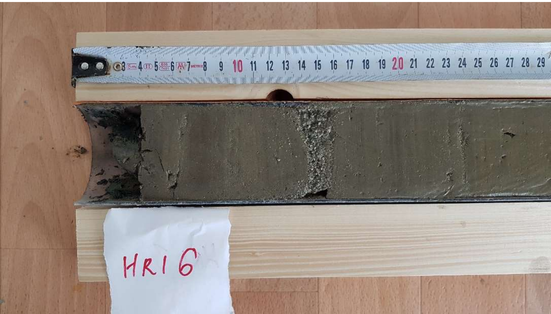
Fotodokumentace vrtného jádra z přehrady Hričov s viditelnou proměnou v zrnitostní frakci sedimentace
