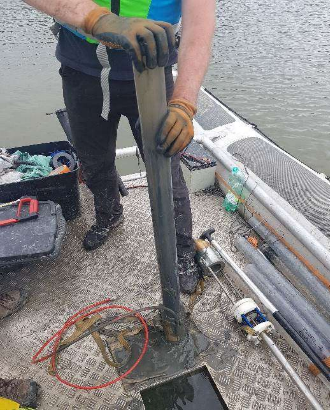
Odebírání vrtného jádra z plovoucí vrtné platformy
