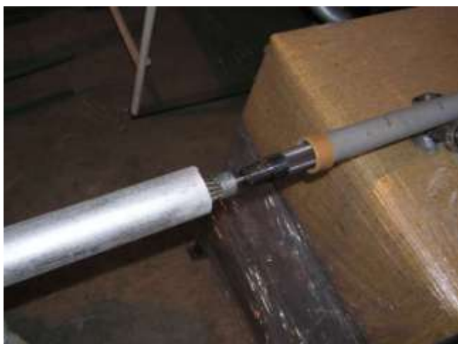
Mechanická dekontaminace trubek
