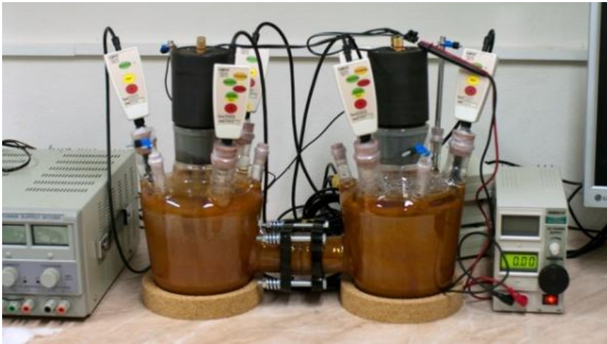
oddělené elektrodivé prostory (iontová membrána)
