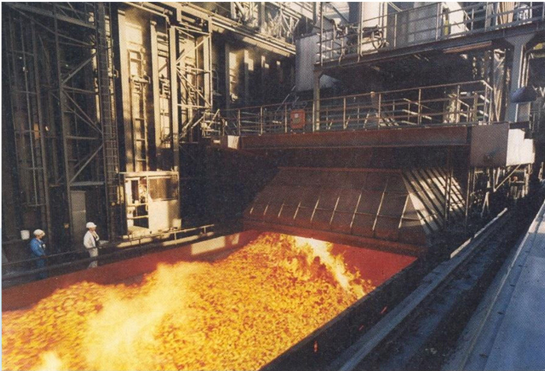
Integrované zařízení na převážení koksu s krytem
