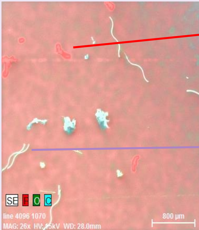
Obrázek 7: EDX analýza směsi mikroplastů
