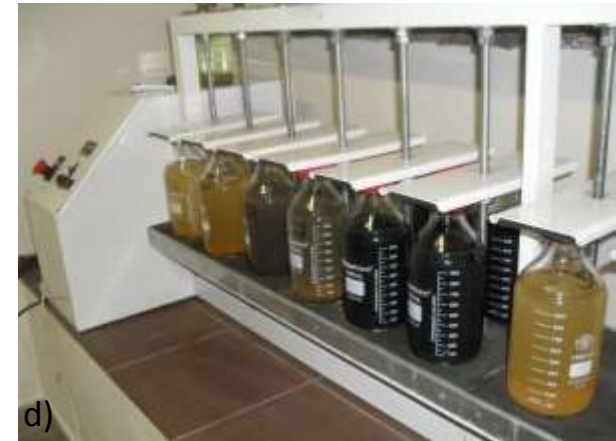
a) makro železo (železné špony), b) mikroželezo (prášek), c) nanoželezo (suspenze) d) rotační třepačka se vzorky
