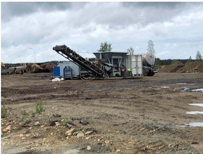
Obrázek 6 – Technologie pro provozní kultivaci a zapravení bakteriálního preparátu spolu s makronutrienty do zeminy před bioremediací
