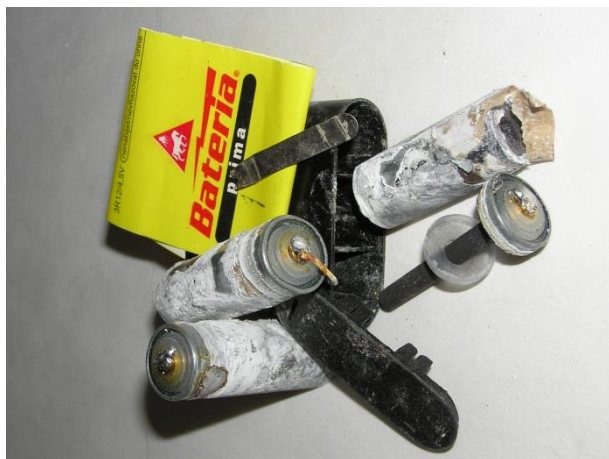
Demontáž ploché 4,5 V baterie
