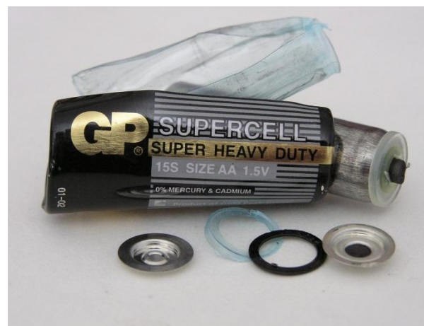
Kompletní demontáž obalu Zn kalíšku článku
