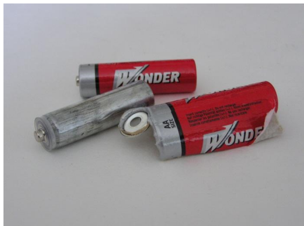
Demontáž lepenkového obalu
