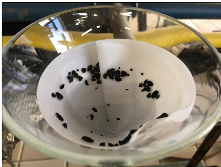
Norit PK 1-3 zachytený po filtrácii
