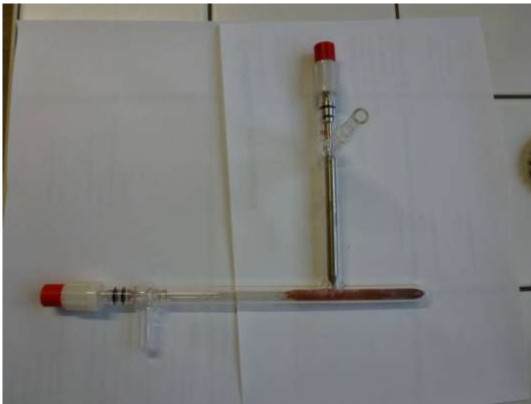
Aparatura pro rozlamování ampulí pod vakuem
