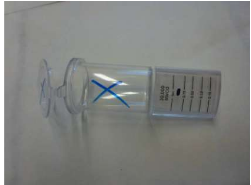
Ultrafiltr Vivaspin 15 pro izolaci a čištění bílkoviny o hmotnosti > 30 kDa.
