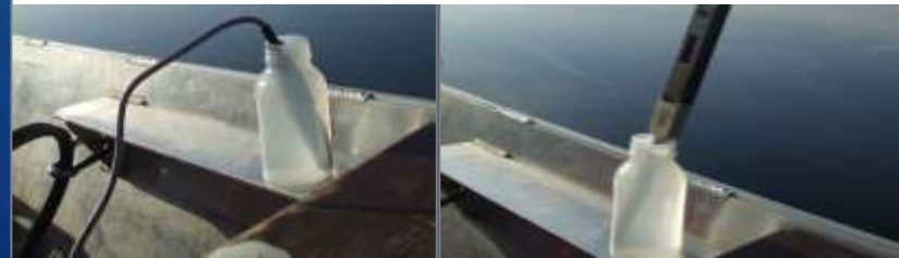
in situ měření pH a konduktivity
