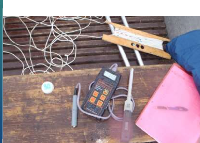
in situ měření pH a konduktivity
