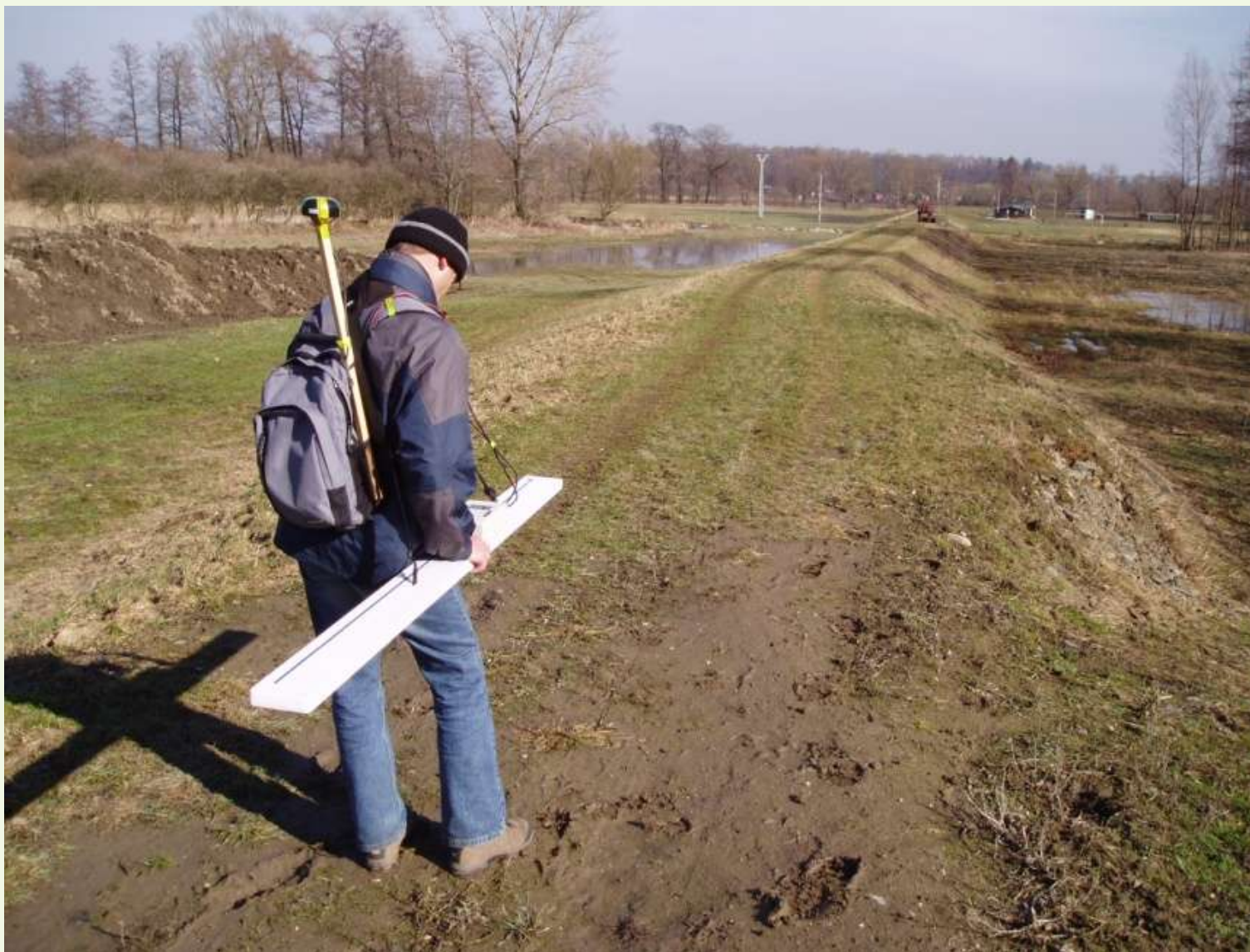
Aparatura GEM-2 při měření v terénu.
