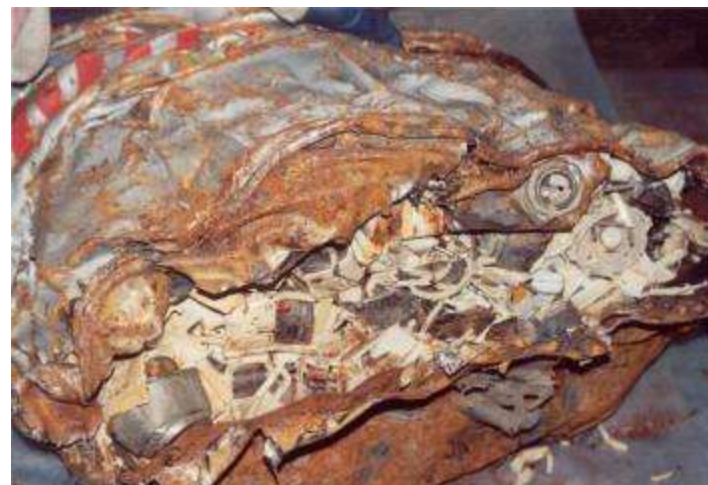
Část 200 l sudu se 155 požárními hlásiči s 241\text{Am} , PDE = 5 \mu\text{Gy/h}
