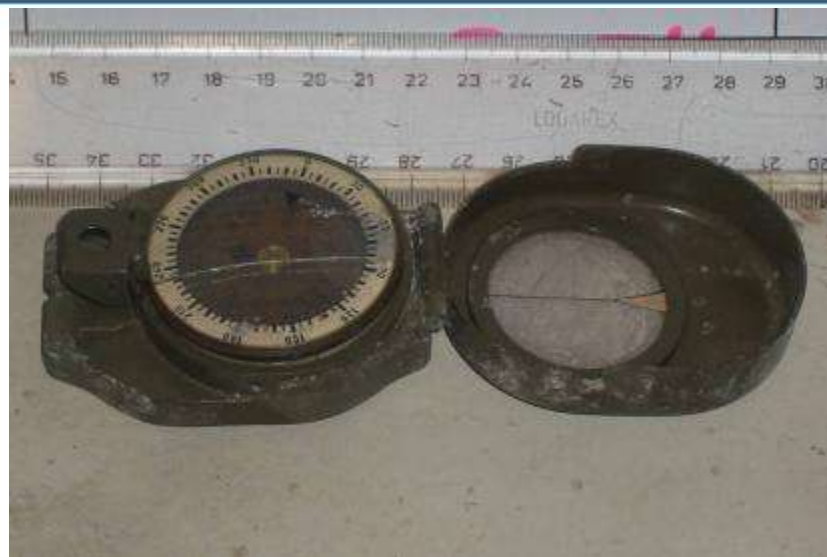
Vojenský kompas s ^{226}\text{Ra} , PDE = 180 \mu\text{Sy/h}
