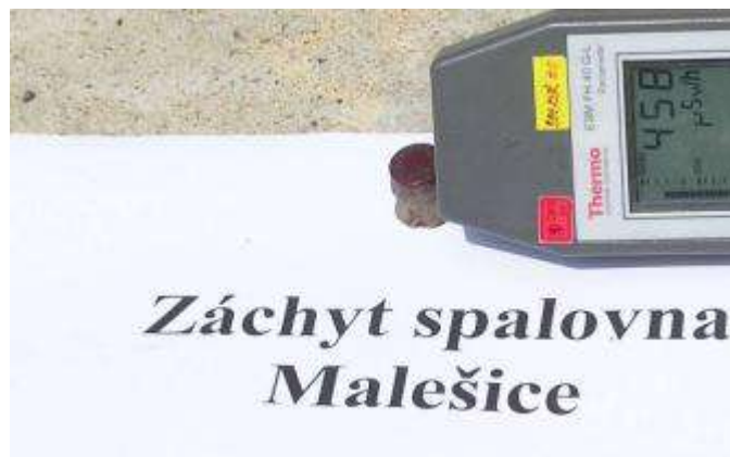
Vojenský kompas s ^{226}\text{Ra} , PDE = 180 \mu\text{Sy/h}
