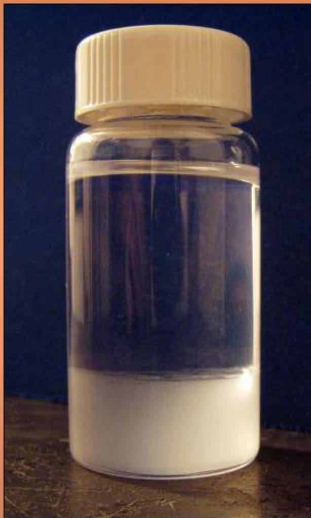
Skleněná měřicí kyveta o objemu 20 mL. Na snímku je patrný rozpad scintilační směsi na dvě nemísitelné složky. Nehomogenní obsah kyvety se projevuje deformací výsledných spekter a může způsobovat i značné podhodnocení výsledků.
