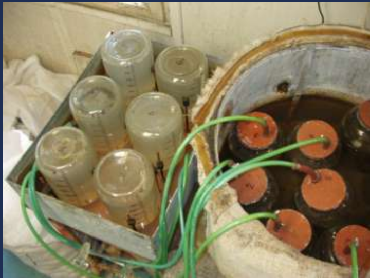
Malé laboratorní fermentory o objemu 3 l
