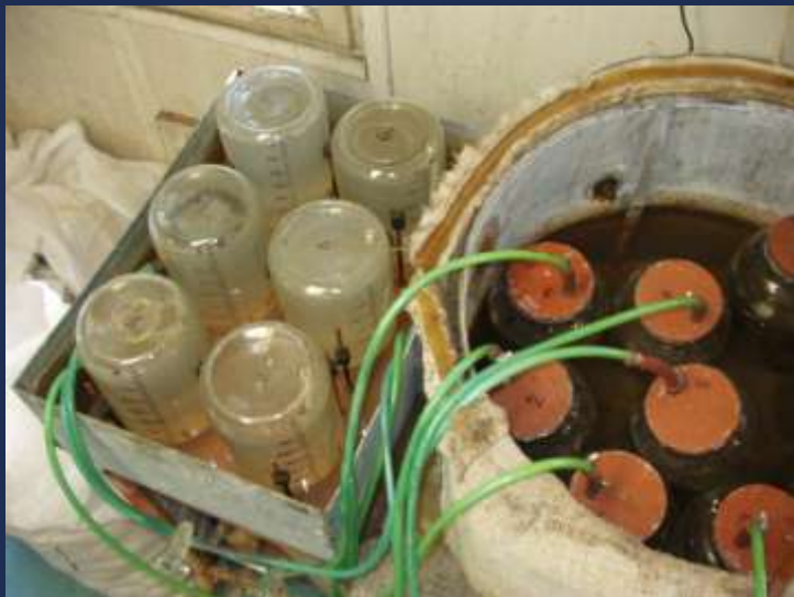
Malé laboratorní fermentory o objemu 3 l
