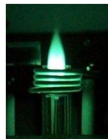
Radiálně a axiálně pozorované plazma
