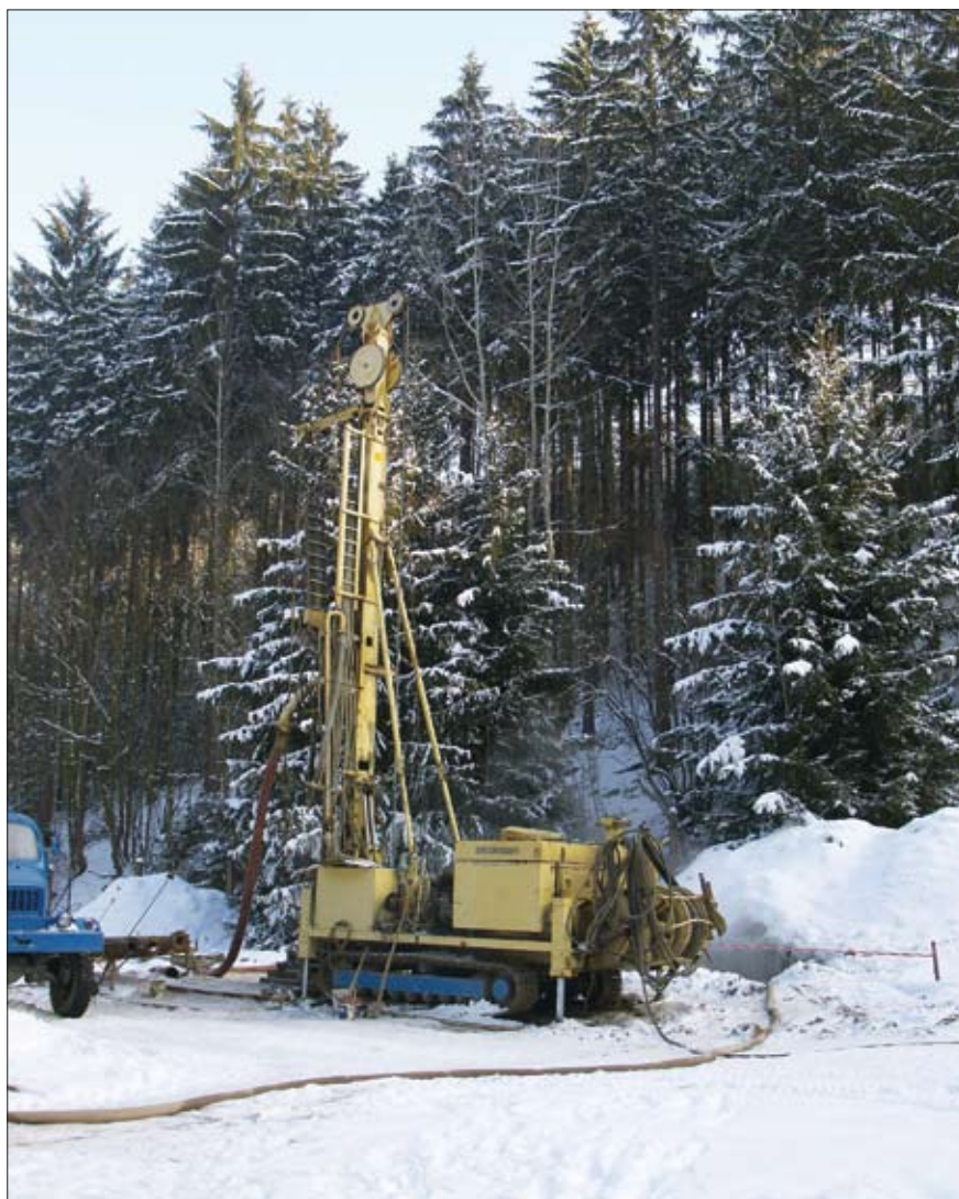
Výplachové hospodářství vrtné soupravy při -20 °C
