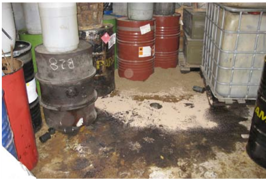
Obr.2: Libčany – chemikálie unikající volně na podlahu objektu
