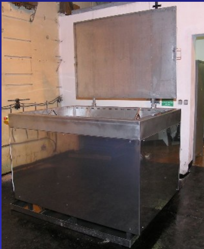
Ultrazvuková vana s ultrazvukovými generátory
