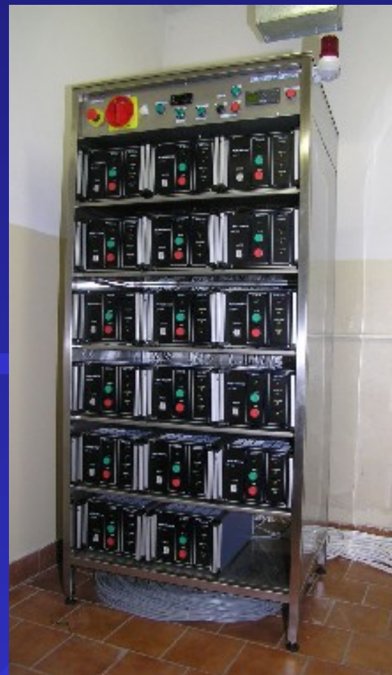
Ultrazvuková vana s ultrazvukovými generátory
