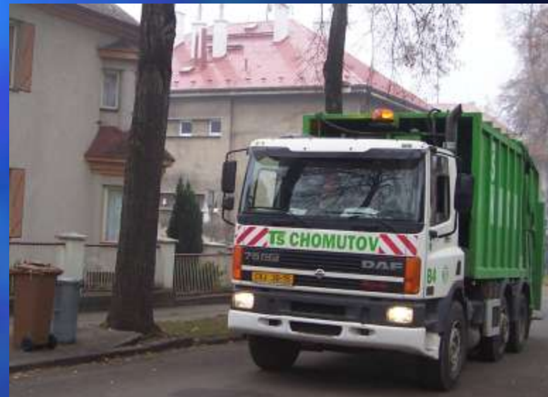
DAF – nástavba BSS Metaco o objemu 20m 3
