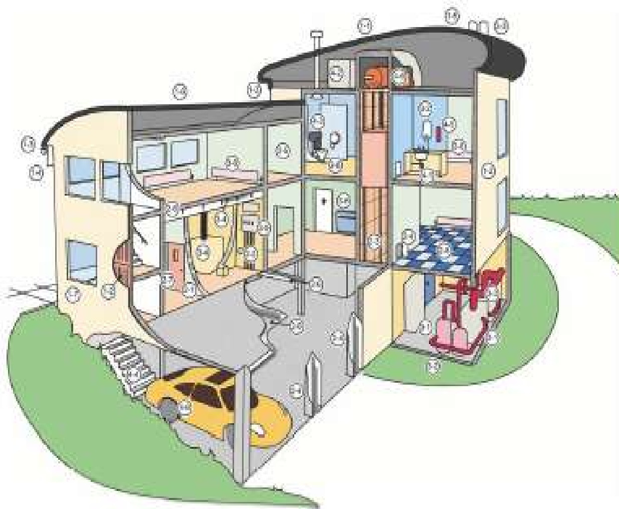
Obrázek 4.1: Budova s azbestem – upozornění na obvyklá místa výskytu materiálů obsahujících azbest.
