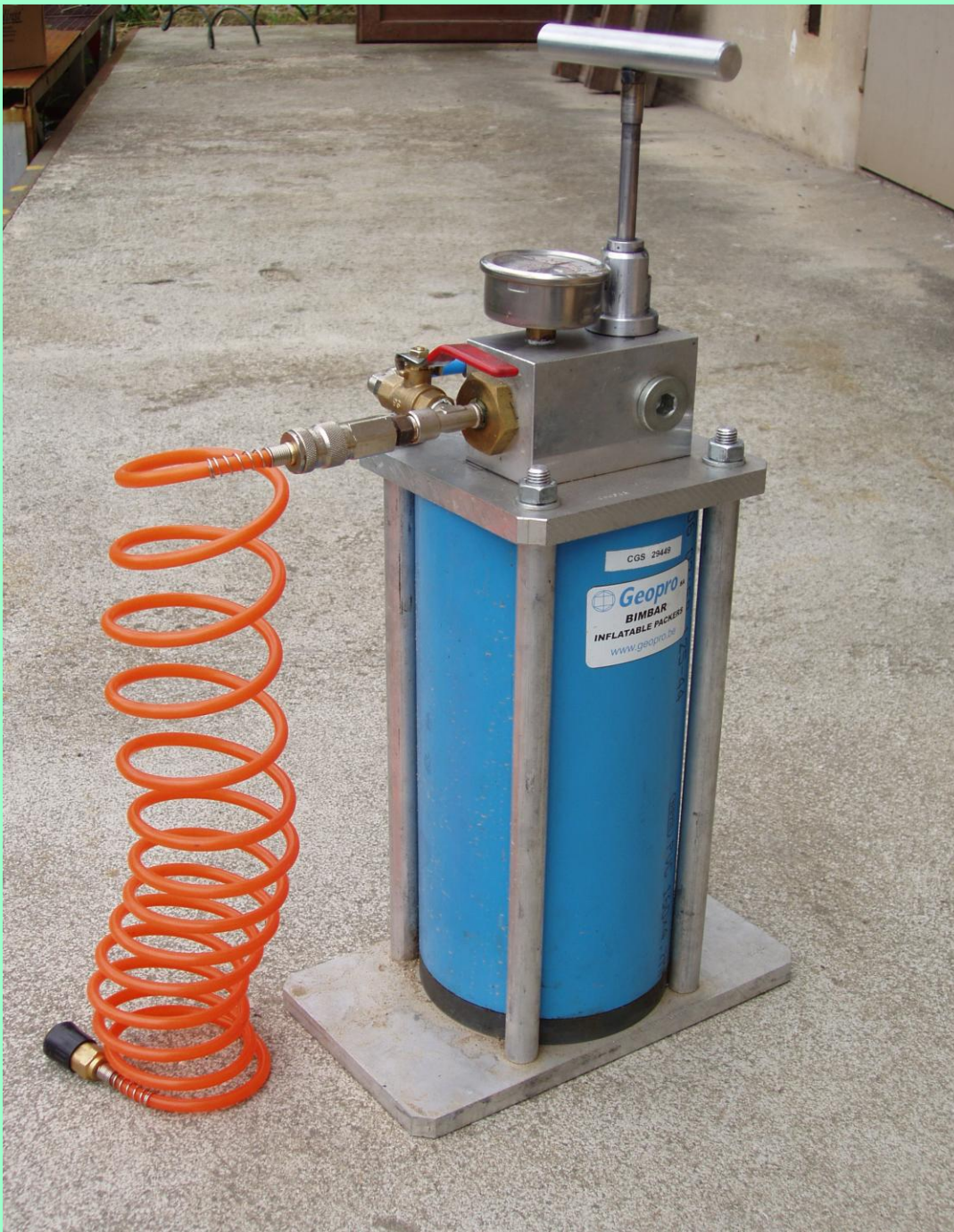
Vysokotlaká pumpa pro nafukování pakru pomocí vody.
