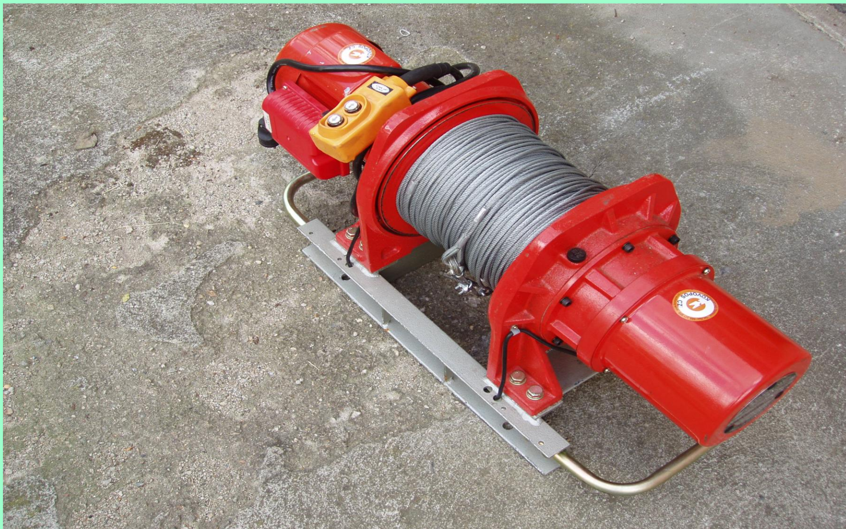
Zařízení na zapouštění sestavy do vrtu.
